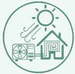
**05 Aerotermia para generación de calor y ACS:** Un sistema de aerotermia nos permite aprovechar la energía del aire para calentar el agua almacenada en un depósito aislado térmicamente y destinada a abastecer a las viviendas de agua caliente sanitaria. Además el mismo sistema, generará calor para calentar las viviendas, sin emisiones de CO2 y reduciendo el impacto ambiental, con un gran ahorro energético y económico.
